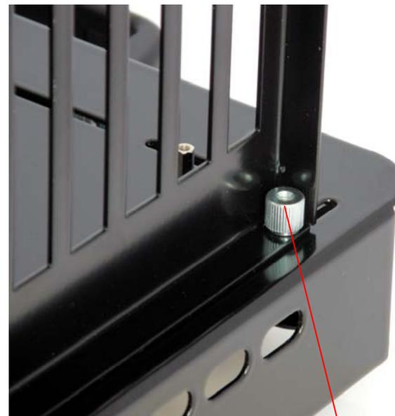
Il **Supporto VGA** viene fissato alla parte Superiore del Banchetto Dimastech® tramite 2 dadi zigrinati M4 e 2 viti M4x10
